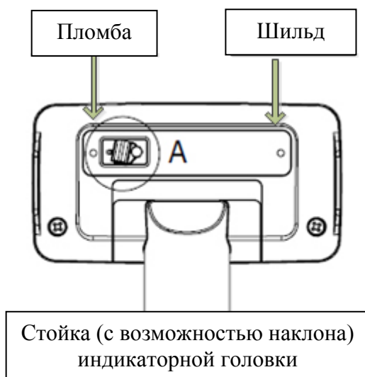
Рисунок 14.1 – Расположение поверочной пломбы весов
